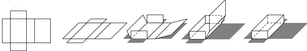
1. Le patron du pavé droit    2. Le même patron en perspective cavalière.    3. On découpe et on plie    4. On colle les arêtes    5. On obtient le pavé droit.
