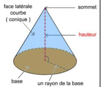
Propriété (admise) : Volume d'un cône de révolution de base de rayon R et de hauteur h.
