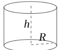
Exemple : Quel est le volume d'un cylindre de révolution ayant 5 cm de hauteur et dont la base a un diamètre de 6 cm ?  $\rightarrow V = \pi \times 3 \times 3 \times 5 = 45\pi \approx 141,37 \text{ cm}^3$
